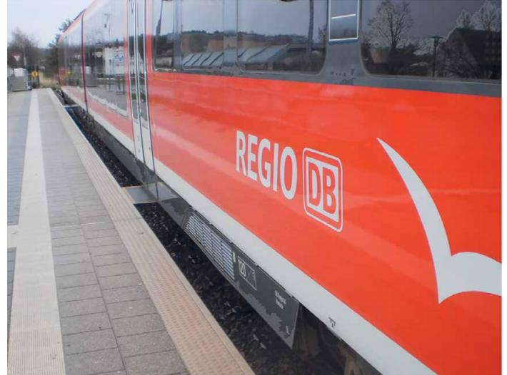
Links: Am 31. Dezember 2012 setzt sich 642 079 in Richtung Rostock in Bewegung, im Hintergrund die Haltestelle Graal-Müritz Koppelweg. Rechts: In die Desiro-Triebzüge kann stufenlos eingestiegen werden, ausfahrbare Schiebetritte überbrücken den Spalt zum Bahnsteig.
